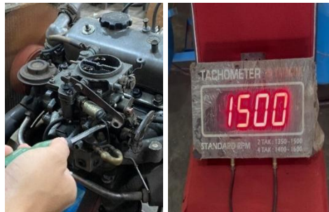
Gambar 5 Penyetelan Rpm dan Tampilan Rpm 1500
