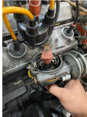
Gambar 2. Pemasangan Pengapian Konvensional
