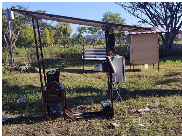
Gambar 5. Mesin irat bambu dengan sumber energi hybrid
