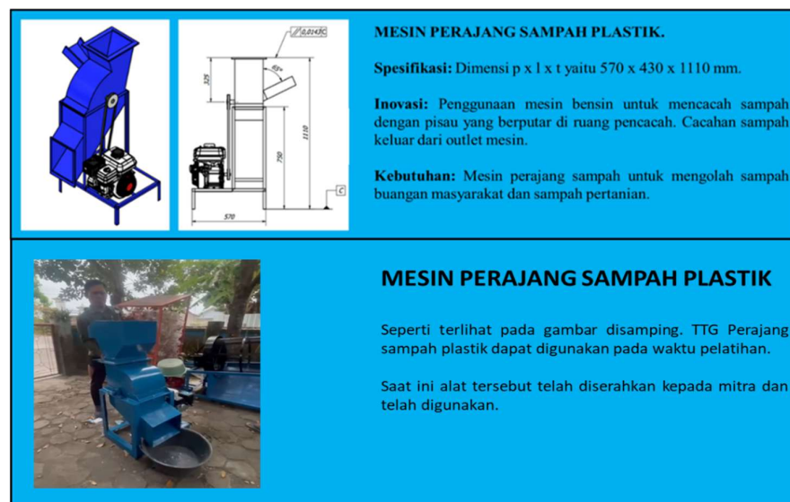
Gambar 7. TTG yang diterapkan : Mesin Perajang Sampah Plastik
