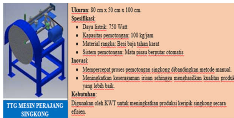
Gambar 3. TTG Mesin Perajang Singkong
