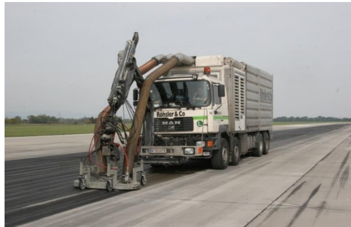
Gambar 3. Pembersihan Rubber Deposit
