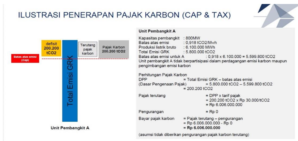
Gambar 7. Ilustrasi Penerapan Pajak Karbon (CAP & TAX) Pembangkit A (ESDM 2022)
