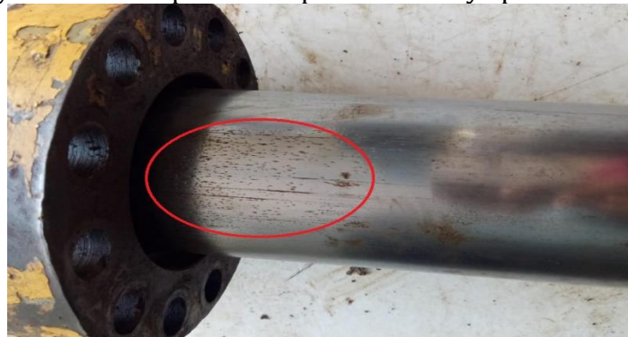
Gambar 10. Kerusakan Tabung Silinder Hidrolis
