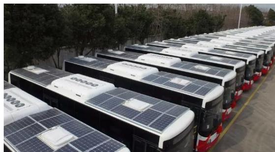
Gambar 7. Pemasangan Panel Surya di Atas Bus
